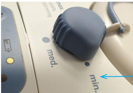
Stellen Sie das Vakuum auf „Minimum“ ein. Schalten Sie das Gerät ein. Bei ungenügender Sogleistung erhöhen Sie die Saugkraft durch Drehen des Schalters auf «Medium» oder «Maximum».
